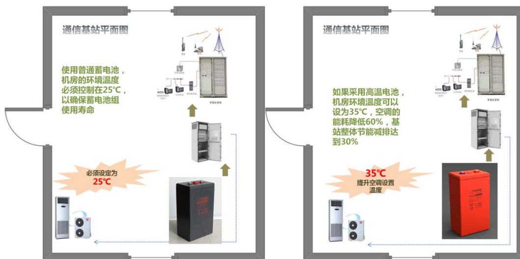
图 2 耐高温型密封电池应用于通信基站示意图
